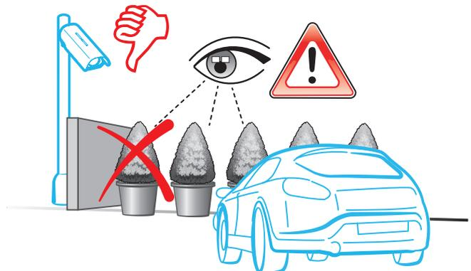
Mettere a fuoco la targa sempre nel punto più lontano dalla telecamera. Avvicinandosi infatti il problema della messa a fuoco si minimizza. Quando si esegue la messa a fuoco, parcheggiare nel varco un'autovettura in modo da mettere a fuoco la targa e non la pavimentazione o il contesto dell'immagine.
