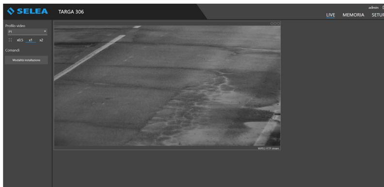
**Menu MEMORIA:** permette di accedere alle informazioni contenute nella memoria **MicroSD** all'interno di **Targa J-T306**: nello specifico permette di visualizzare e caricare/scaricare snapshot e liste. In memoria possono essere caricati file con estensione TXT per le liste delle targhe (Blocco note di Windows come editor va benissimo), l'importante è che su ogni riga vi sia una singola targa e nel file non siano contenuti commenti o testo.
