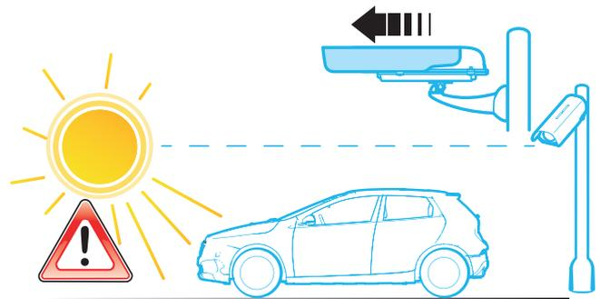
In caso di varchi dove si pretende la lettura della targa anteriore, canalizzare i veicoli e riprendere la targa quando il veicolo è fermo. Evitare di posizionare la telecamera molto prima del cancello in modo che il veicolo passando (in movimento!) legga la targa, così da trovarlo aperto quando si arriva davanti ad esso.
