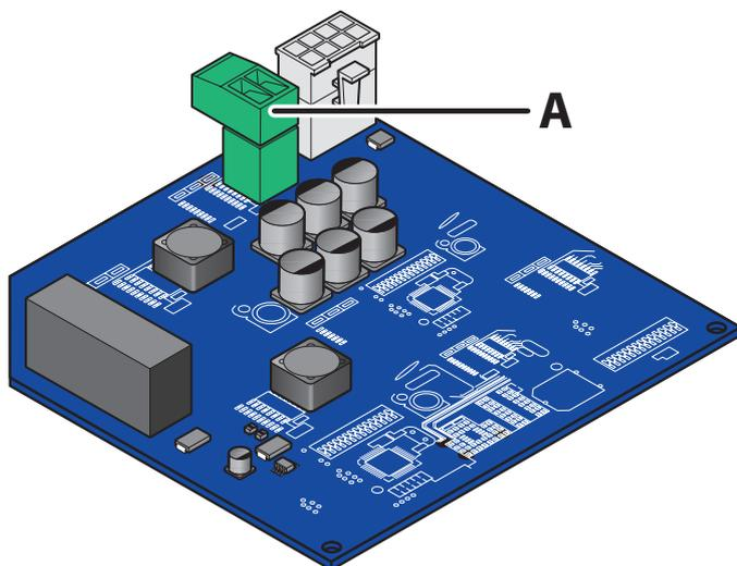
**A** Connettore per alimentazione **12Vdc** esterna alla scocca. Utilizzare alimentatori da almeno **35W/telecamera**.
