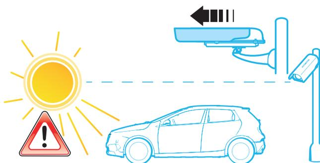
In caso di varchi dove si pretende la lettura della targa anteriore, canalizzare i veicoli e riprendere la targa quando il veicolo è fermo. Evitare di posizionare la telecamera molto prima del cancello in modo che il veicolo passando (in movimento!) legga la targa, così da trovarlo aperto quando si arriva davanti ad esso.
