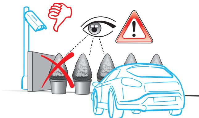
Mettere a fuoco la targa sempre nel punto più lontano dalla telecamera. Avvicinandosi infatti il problema della messa a fuoco si minimizza. Quando si esegue la messa a fuoco, parcheggiare nel varco un'autovettura in modo da mettere a fuoco la targa e non la pavimentazione o il contesto dell'immagine.
