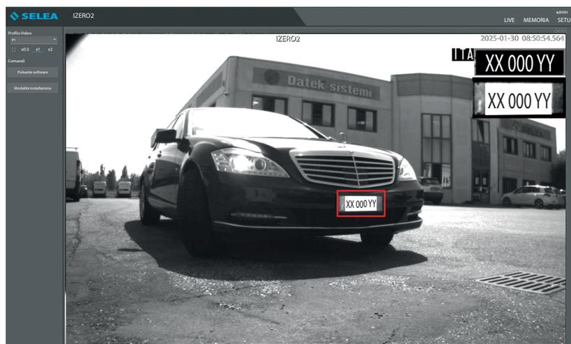
**Menu MEMORIA:** permette di accedere alle informazioni contenute nella memoria **MicroSD** all'interno di **iZero 2**: nello specifico permette di visualizzare e caricare/scaricare snapshot e liste. In memoria possono essere caricati file con estensione TXT per le liste delle targhe (Blocco note di Windows come editor va benissimo), l'importante è che su ogni riga vi sia una singola targa e nel file non siano contenuti commenti o testo.
