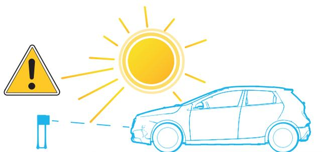
In caso di varchi dove si pretende la lettura della targa anteriore, canalizzare i veicoli e riprendere la targa quando il veicolo è fermo. Evitare di posizionare la telecamera molto prima del cancello in modo che il veicolo passando (in movimento!) legga la targa, così da trovarlo aperto quando si arriva davanti ad esso.
