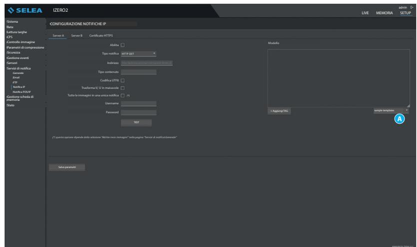
Premendo il tasto **"A"** visibile nella figura sottostante, è possibile precaricare dei modelli standard, validi per la maggioranza delle situazioni. Se ve ne fosse la necessità potrete aggiungere ulteriori **TAG** premendo l'apposito tasto sulla scheda.
