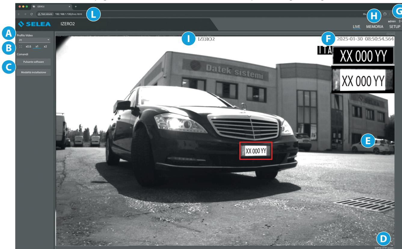
**A** Pulsante con menu a tendina per la scelta del profilo video: in base alla telecamera in uso ci sono 2 tipologie di scelta, **Sensore targa (profilo 1)** - **Sensore targa (profilo 2)**, quella selezionata sarà quella visualizzata nella schermata di **live-view**.
