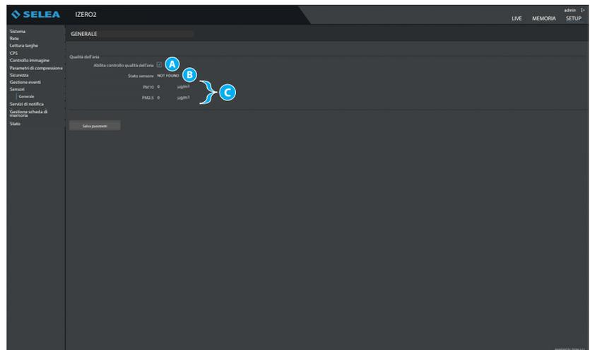
I software terze parti possono estrarre i valori letti dal sensore mediante la seguente chiamata HTTP GET: **<https://IPcamera/cgi-bin/pollution.php>** che restituirà un JSON con le informazioni del sensore come nel seguente esempio {"status": "OK", "PM10": 4, "PM2\_5": 3}.
