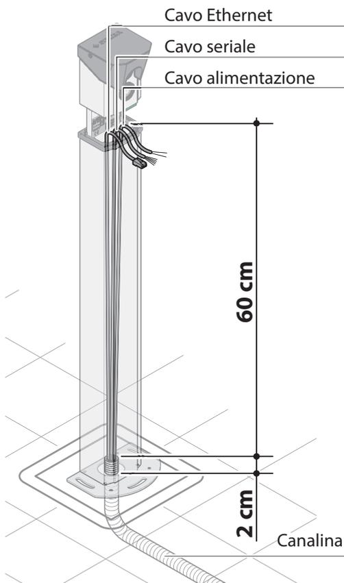
La prima operazione da fare è quella della stesura dei cavi (alimentazione, cavo di comunicazione seriale, Relè e cavo di rete Ethernet) necessari per il funzionamento dell'impianto e l'integrazione con il resto del sistema.
